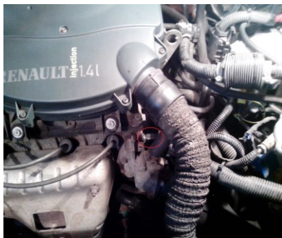
Рисунок 2 – Розташування датчика температури охолоджуючої рідини на двигуні Renault K7J
