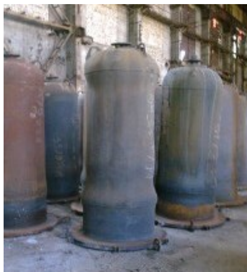
Рисунок 1 – Реторти (реактори) магнійтермічного виробництва титану
