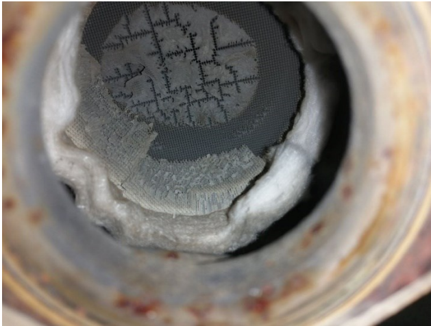
Рисунок 4 – Пошкодження каталізатора автомобіля Hyundai Grandeur
