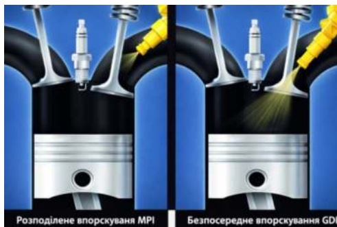
Рисунок 1 – Принцип дії прямого впорскування GDI
