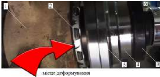
Рисунок 1 – Процес установки підшипника маточини колеса:
