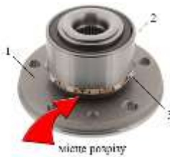
Рисунок 3 – Приклад застосування старого розрізного кільця:
