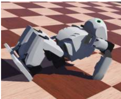
Рисунок 3 – Приклад підйому роботу для випадку, якщо він впав на спину
