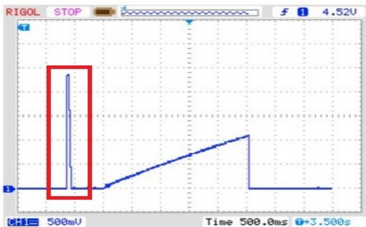
Рисунок 1 – Процес виміру параметрів конденсатора з номіналом 22 пФ
