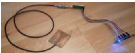
Рисунок 3 – Макет антени Вівальді на підкладинці 1,5 мм з текстоліту FR4
