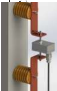
Рисунок 1 – Включення датчика для контролю струму витоку ОПН в шину заземлення
