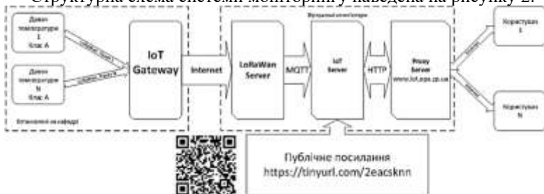
Рисунок 2 – Структурна схема системи моніторингу.
