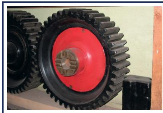
Рис. 3 – деталь «Шестерня» після механічної обробки
