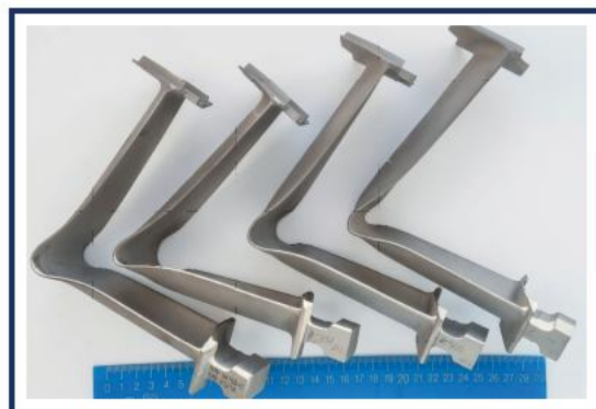
Рис. 2 – Загальний вигляд робочих лопаток після випробування на згин (а) та зона згину під кутом 120° (б)
