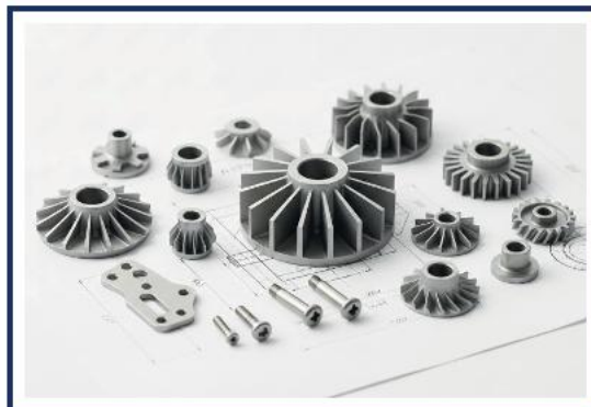
Рис. 4 – Деталі ГТД, отримані селективним лазерним спіканням, які можна зміцнювати алмазним вигладжуванням
