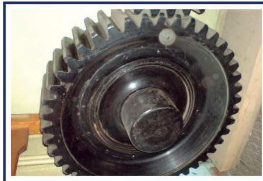
Рис.2 – деталь «Шестерня» після наплавлення
