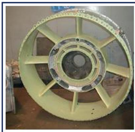
Рис. 2 – Деталь «корпус компресора низького тиску», × 0,2
