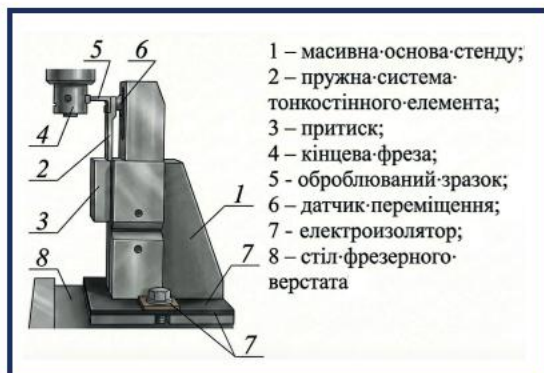
Рис. 3 – Конструкція еспериментального стенду для дослідження динамічних процесів під час фрезерування тонкостінних деталей
