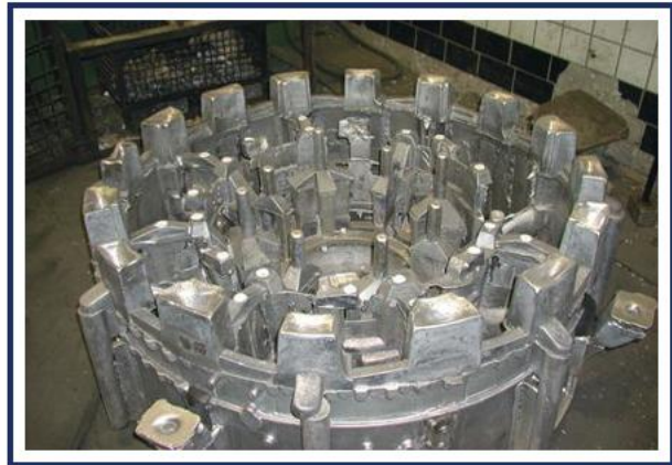
Рис. 1 – Виливок «корпус компресора низького тиску», \times 0,2
