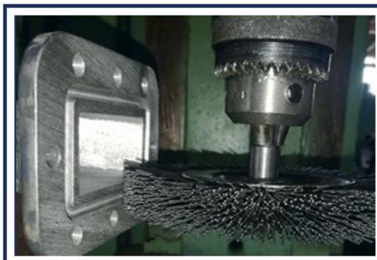
Рис. 2 – Автоматизація полірування фланців прямокутних хвилеводів за допомогою йоржикової та дискової ПАЩ на фрезерному верстаті з ЧПК
