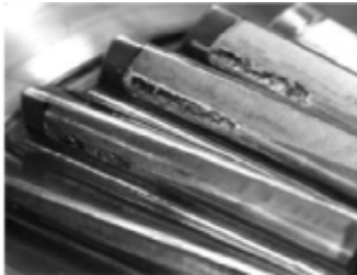
Рисунок 1 – Вищерблювання зубчастих коліс
