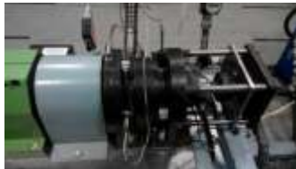
Рисунок 1 – Зовнішній вигляд випробувальної головки з приводом стенду
