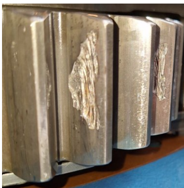
Рисунок 1 – Викришування зубів зубчастого колеса авіаційного редуктора
