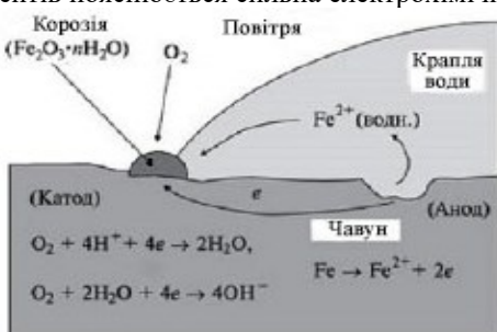
Рисунок 1 – Схема атмосферної корозії.
