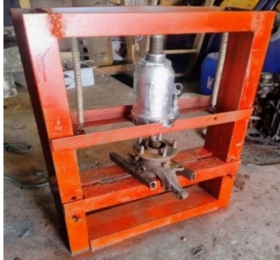
Рисунок 1 – Фотографія гідравлічного пресу власного виготовлення
