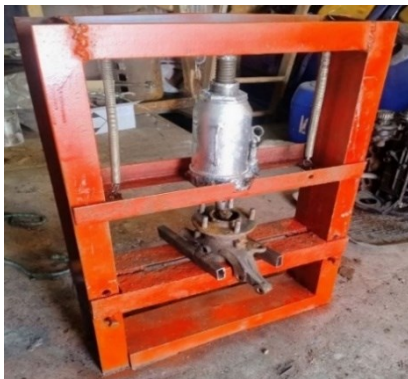
Рисунок 1 – Фотографія гідравлічного пресу власного виготовлення
