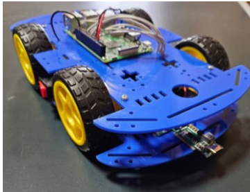
Рисунок 1 – Прототип роботизованого транспортного засобу на базі Raspberry Pi
