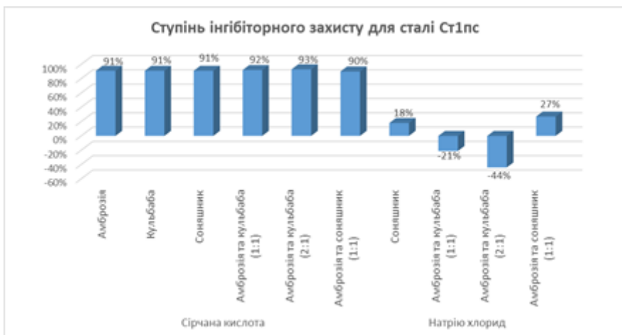
Рисунок 1 – Ступінь інгібіторного захисту для сталі Ст1пс у 10%-му розчині H_2SO_4 та 3%-му розчині NaCl .
