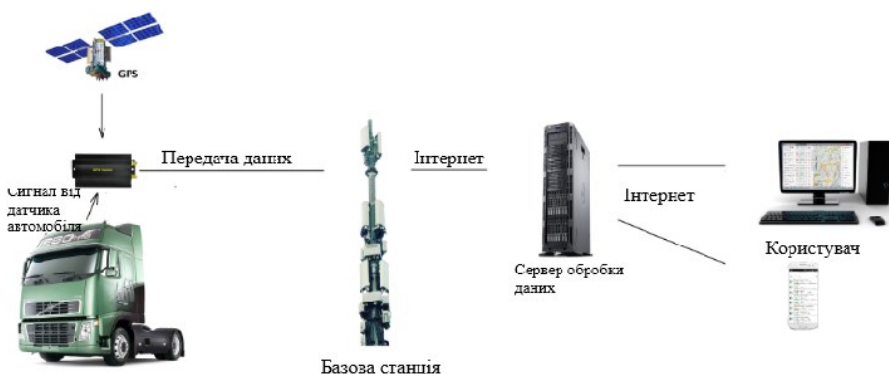
Рисунок 1 – Принцип відслідковування техніки за допомогою GPS-трекерів.
