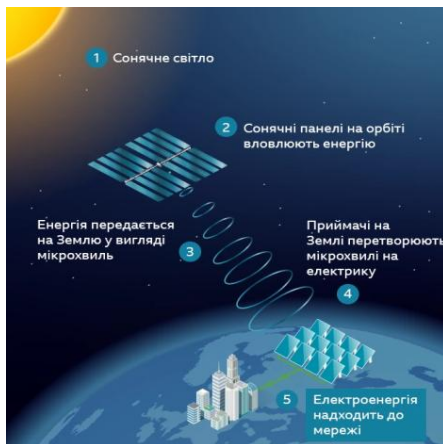
Рисунок 1 – Схема постачання сонячної електрики на Землю.
