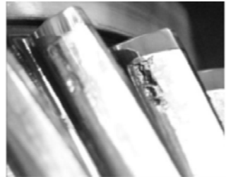
Рисунок 1 – Вищерблювання зубчастих коліс
