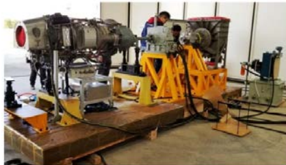
Рисунок 2 – Повітряний динамометр V35 налаштований для тестування двигунів вертольота в умовах великої висоти/низьких температур [1]
