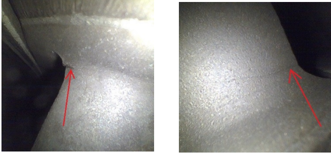
Рисунок 1 – Невідповідність на лопатка НА компресора високого тиску
