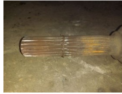
Рисунок 1 – Шліцьове з'єднання проміжної опори з валом вилки шарніра
