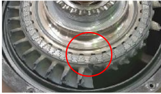
Рисунок 4 – Обрив лопатки турбіни компресора разом з полицею хвостовика з причини розвитку втомної тріщини.
