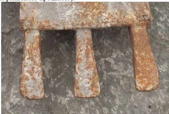
Рисунок 1 – Зовнішній вигляд зношених зубів
