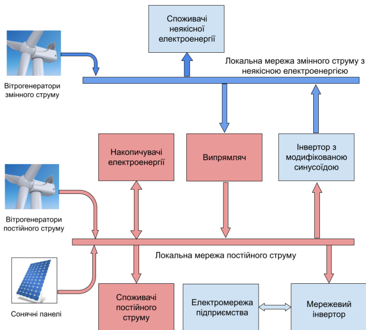
Рисунок 1 – Блок-схема підключення поновлювальних джерел енергії до електромережі промислового підприємства.
