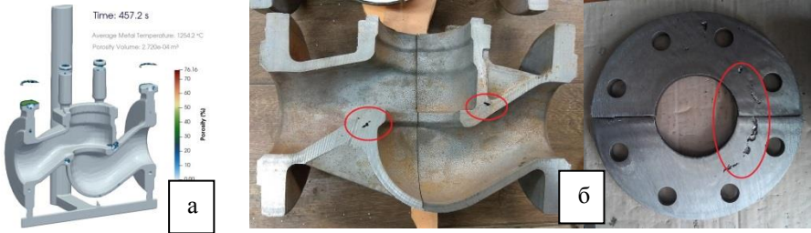
Рисунок 1 – Усадкові дефекти: а – результат моделювання поруватості, б – розріз реального виливка
