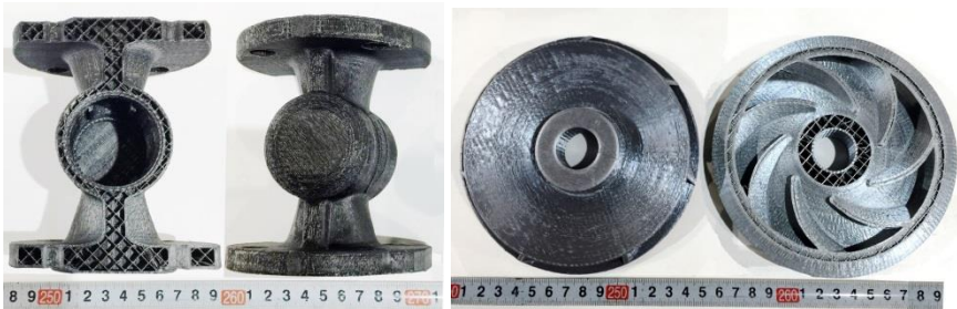
Рисунок 1 – Друковані моделі корпусу трубної арматури та турбіни (крыльчатки) насоса
