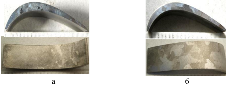
а – до ГП; б – після ГП + термічна обробка.
