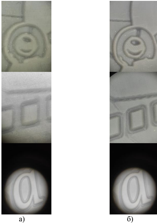
а) моделі, виготовлені на принтері Anicubic Mono X (час засвічування 3 с, товщина шару 0,05 мм); б) моделі, виготовлені на принтері Phrozen Mighty 8K (час засвічування 3 с, товщина шару 0,03 мм);
