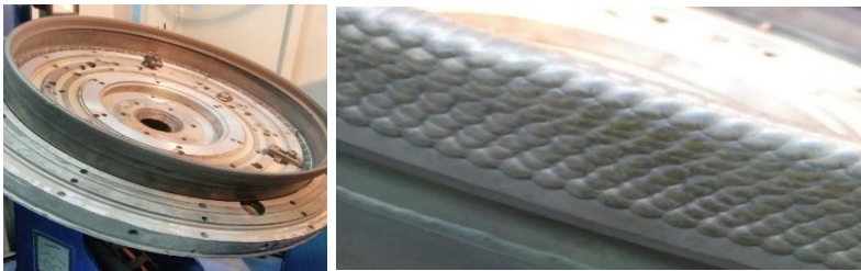
Рис. 1 – Деталь після відновлення методом мікроплазмового наплавлення. а – загальний вигляд деталі, б – наплавлені шари
