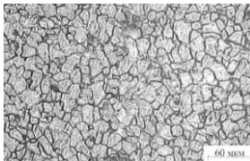
Рисунок 2 – Мікроструктура деформованих зразків сталі при температурі деформації 770 °С (×360)
