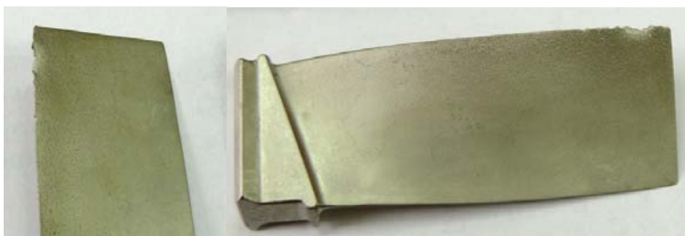
Рисунок 1 –Лопатки I-го ступеня дв. ТВЗ-117 із пошкодженнями пера.
