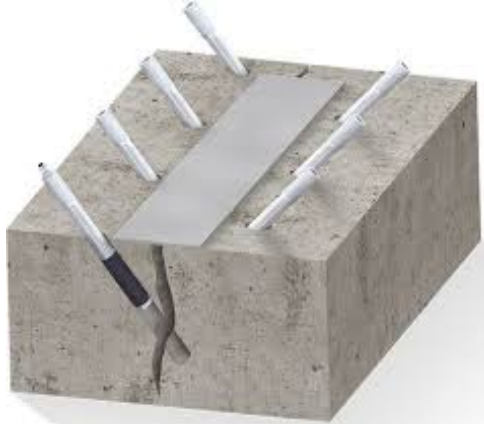
Рисунок 1 – Усунення тріщин методом ін'єктування
