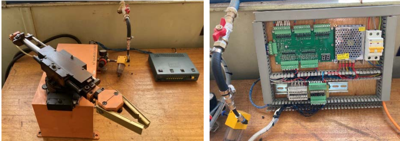
а б а – маніпулятор МП-9С та пульт ручного керування; б – мікроконтролерна частина лабораторного стенду. Рисунок 1 – Мехатронна САК пневматичним маніпулятором.
