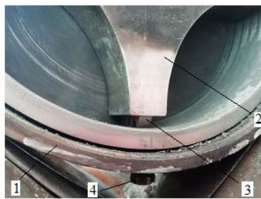
а – загальний вид без передньої кришки: 1 – корпус камери; 2 – зразок-кільце; 3 – ротор; 4 – опорна станина стенду; 5 – вал підшипника ротора; 6 – продукти зношування покриття; б – крило ротора з пластиною: 1 – зразок-кільце; 2 – корпус крила ротора із внутрішнім пазом; 3 – пластина з гребінцями; 4 – нижній гвинт фіксації зразка-кільця Рисунок 2 – Випробувальна камера
