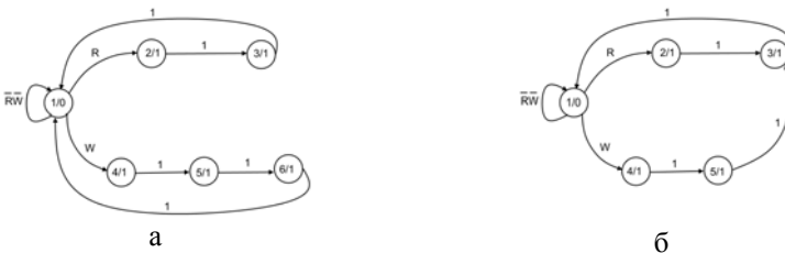
а – діаграма станів цифрового автомата ПЛЛ; б – мінімізована діаграма станів цифрового автомата ПЛЛ
