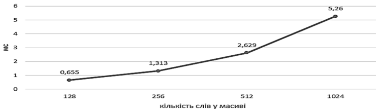
Рисунок 1 – Залежність часу роботи від кількості слів у масиві
