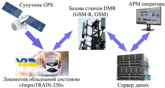
Рисунок 2 – Цифровий радіозв'язок в системі локомотивної безпеки «ImproTRAIN-250»
