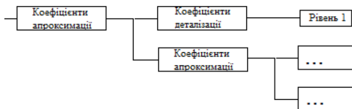
Рисунок 2 – Схема послідовності дій у алгоритмі Малла
