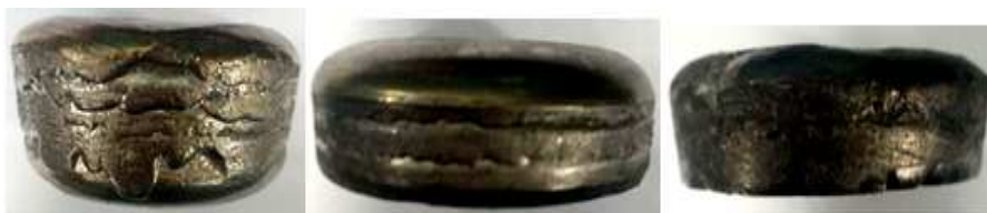
а – 90% Ar+10% He; б – 80% Ar+20% He; в – 70% Ar+30% He. Рисунок 1 – Бокові поверхні експериментальних зразків
