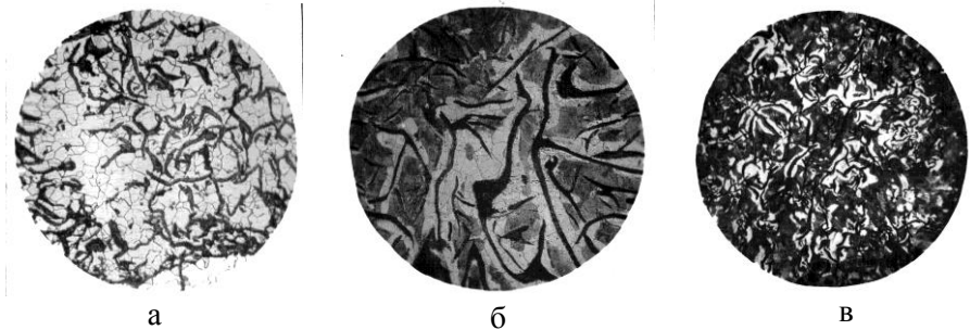
Рисунок 1.5 – Мікроструктури металевої основи сірих чавунів ( \times 100 , травлено 4-х % розчином азотної кислоти): а – феритна; б – ферито-перлітна; в – перлітна (5 % фериту)
