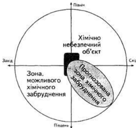
Рисунок 2.2 – Нанесення зон зараження НХР на схеми (карти)
