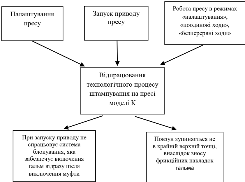
Рисунок 2.1 - Схема відпрацювання технологічного процесу штампування на пресі моделі КД 2130
