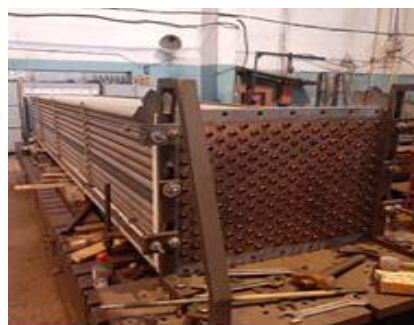
Трубна решітка газоохолоджувача з трубним пучком на стенді для збирання
