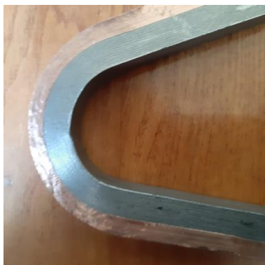
Згин зразка через призму R=3\text{мм} на кут 150^\circ
